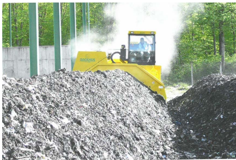
Рисунок 1.1 – Робота машини для перевертання компостних буртів (джерело: https://tehnix.hr/en/ )
