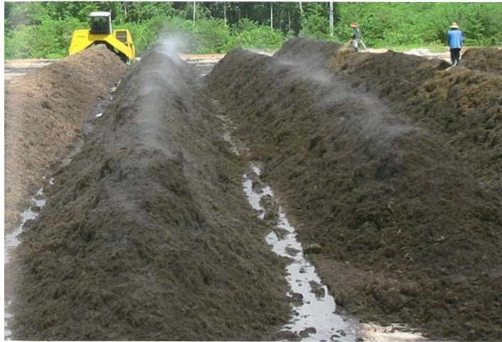
Рисунок 1.9 – Приклад «димного» ефекту в системі компостування у відкритих буртах трикутної форми (джерело: https://tehnix.hr/en/ )
