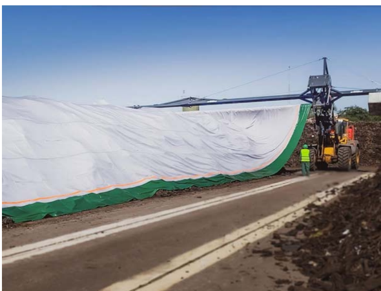
Рисунок 1.6 – Приклад системи компостування у буртах з мембраною (джерело: https://www.compost-systems.com/en/products )
