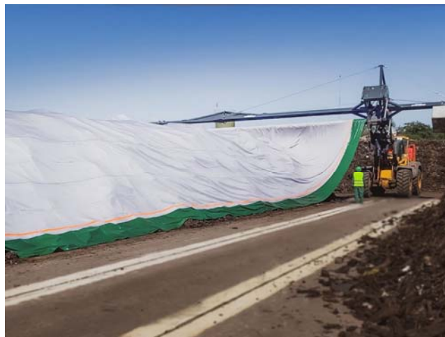
Abbildung 1.6 – Ein Beispiel für ein Kompostierungssystem an den Seiten mit einer Membran (Quelle: https://www.compost-systems.com/en/products )
