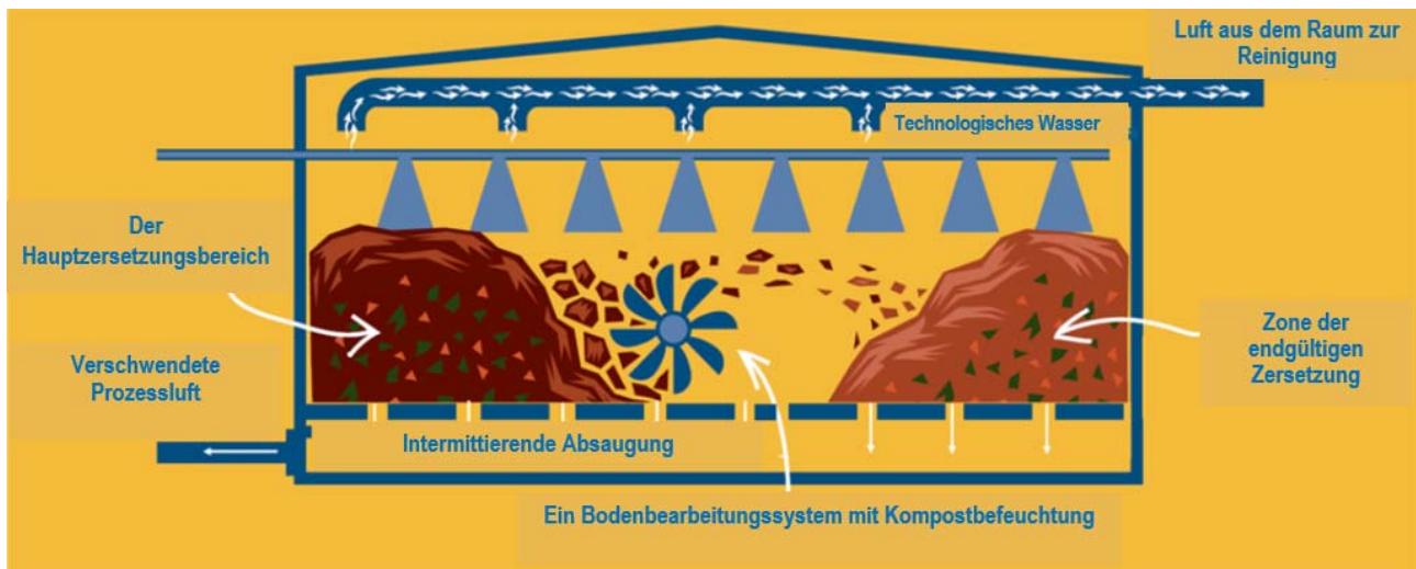
Abbildung 1.5 – Schema des Kompostierungsprozesses in überdachten Mieten
