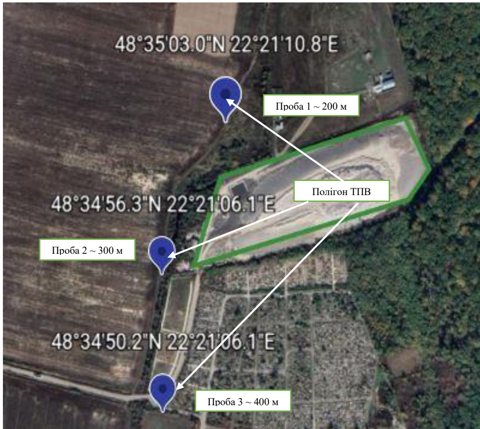
Рис. 3.14. Схема відбору проб повітря для встановлення впливу полігону ТПВ у с. Барвінок
