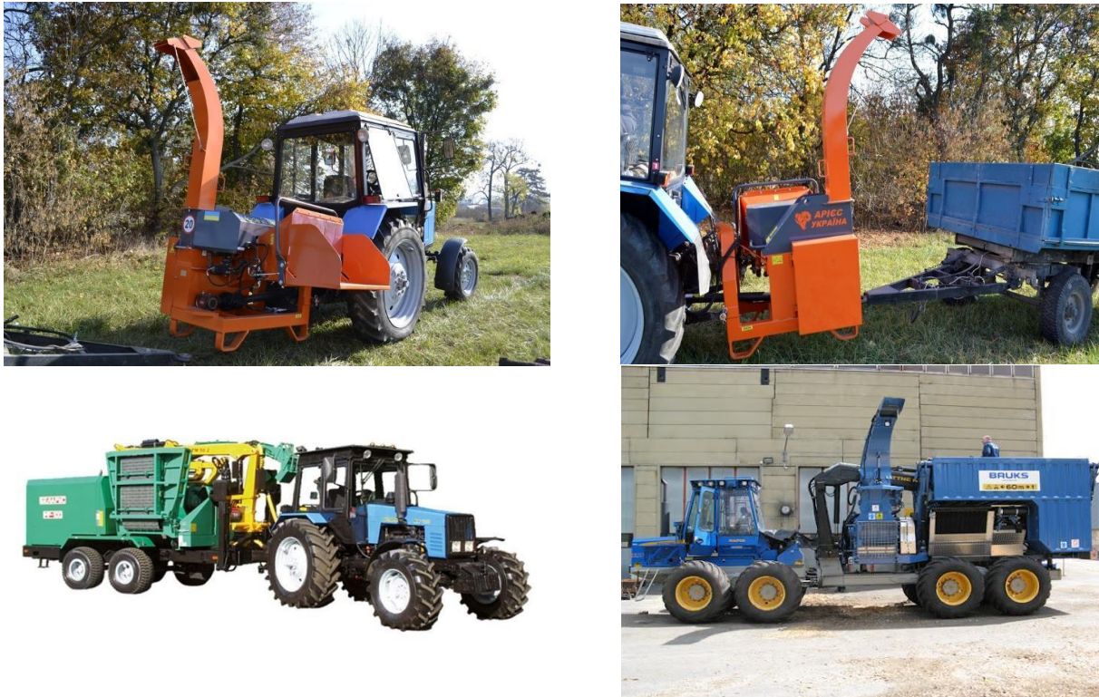
Рис. 5.2. Пристрій для подрібнення відходів від зелених насаджень (на базі трактора)
