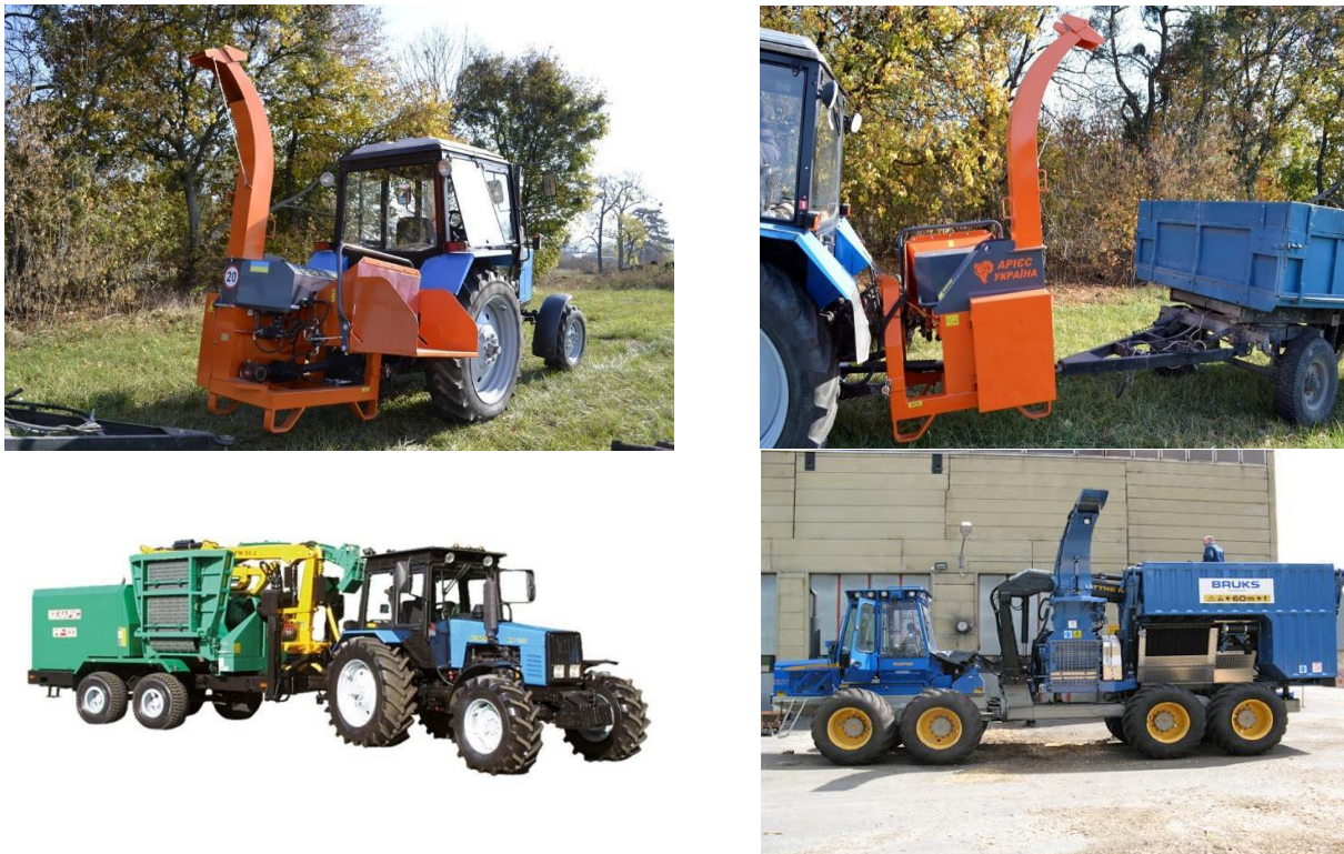
Abb. 5.2. Ein Gerät zum Zerkleinern von Abfällen aus Grünflächen (auf Basis eines Traktors)
